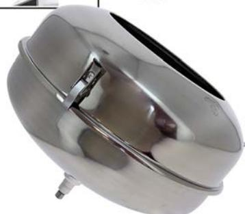
Der Dragierkessel eignet sich für das Dragieren und das Überziehen von Trockenfrüchten (Mandeln, Haselnüsse, usw.) mit Schokolade, Marzipan usw. In ihm lassen sich in 30 Minuten 6 bis 80 kg Süßwaren herstellen. Verbessertes Befestigungssystem. Der doppelwandige Kessel aus Edelstahl passt auf die Küchengeräte:
